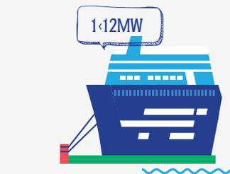
La puissance maximale demandée par les plus grands paquebots est de 12 méga watts (MW). **Les puissances s'échelonnent de 1 à 12 MW lorsqu'ils sont à quai.** On multiplie au maximum par 3 en manœuvre et 5 en navigation pour obtenir la vitesse maximale. En revanche, la plupart des navires pratiquent des vitesses de croisière qui permettent de n'utiliser que la moitié de cette puissance disponible pour notamment économiser du carburant et de ce fait polluer moins.
