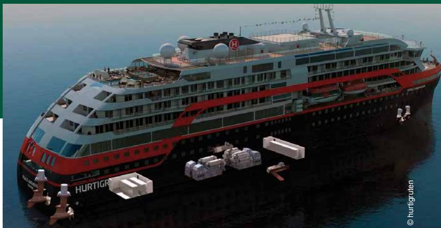
Le navire MS Roald Amundsen est propulsé par quatre moteurs et deux blocs de batteries.
